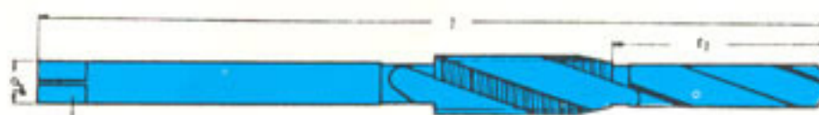
ferra-Kombi-Gewindebohrer HSSE 10 für metrische ISO-Gewinde.
